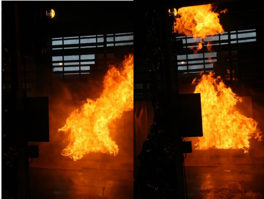
Figur 35 – Flambild när skärsläckaren är aktiv (sprayen rör sig från vänster till höger i bild) till vänster jämfört med ej aktiv till höger (Foto: Ulf Wickström)
