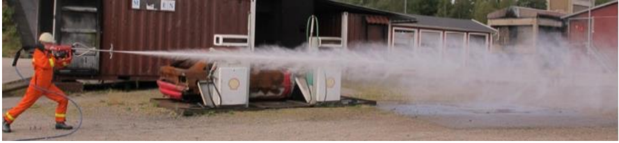
Figur 8 – Spraybild från skärsläckare [1]
